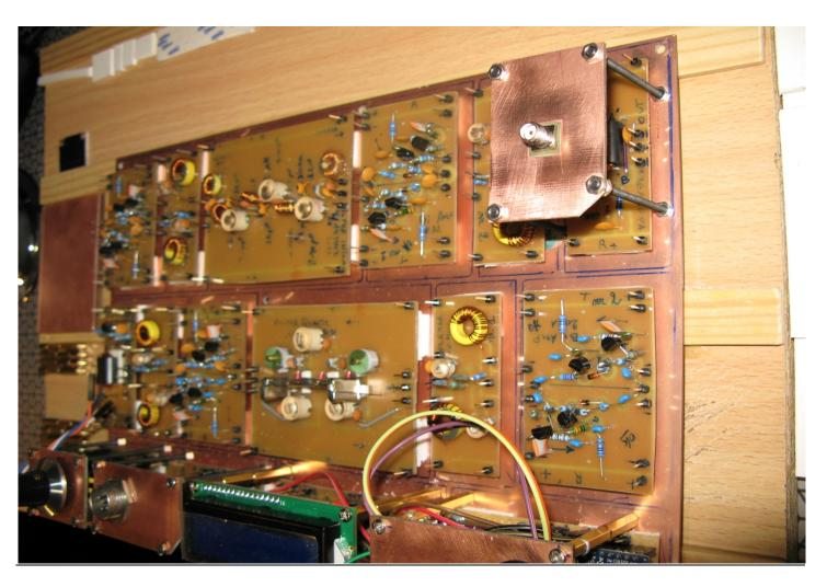
Surprise, la face avant fait son apparition. Les leds TX/RX, Le bouton on/off, l'alimentation 12V. Et l'emplacement pour le lcd 1602. Manque encore les passages pour le volume, la fiche micro, la prise SMA.
